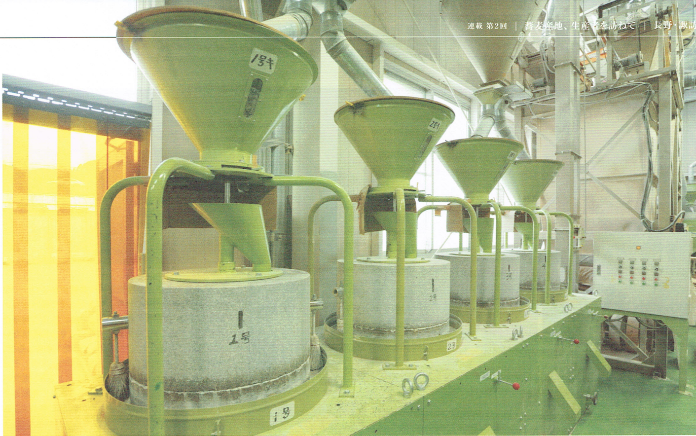
高山製粉の工場の中では60台の石臼が低い音を響かせて回り続けている。石臼は1台ずつ大きさが異なり、回転数もさまざま。個々の石臼の能力や特性にふさわしい粉が挽けるように調節されて使われている。これらの石臼から、全国のそば好きが笑顔になるおいしいそば粉が挽き出される。
